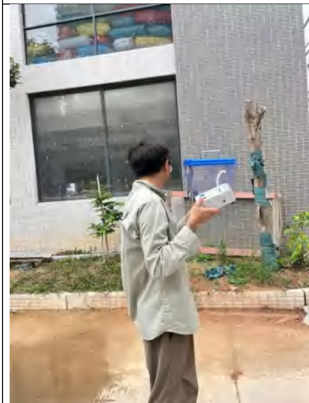
厂区内废气采样
